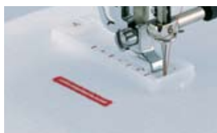
ВЫПОЛНЕНИЕ ПЕТЛИ В ЧЕТЫРЕ ПРИЕМА
