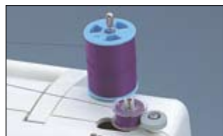
Автоматическое отключение намотки шпульки
