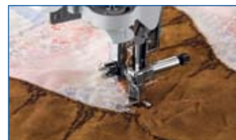
Лапка "О" с открытым мыском для стежки со свободной подачей материала
